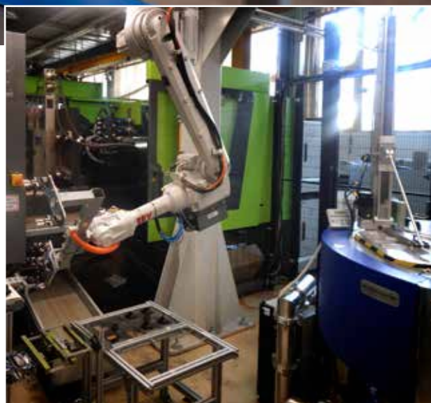
INLINECOATER™R i en helautomatiserad produktionscell för tillverkning av fordonsreflektorer hos Iskra Mehanizmi i Slovenien.
